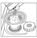
1. Выньте нижнюю корзину и отвинтите крышку бачка против часовой стрелки.
