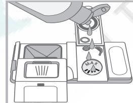
1. Откройте дозатор "D", нажав на язычок на крышке и подняв его;
