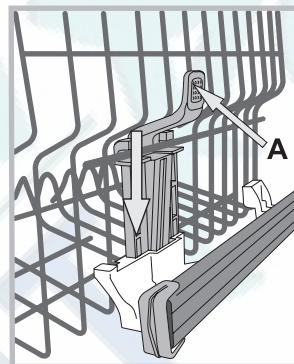
Если корзина оснащена Lift-Up\* (см. схему), поднимите корзину, взявшись за нее с боков и переместив ее вверх. Для опускания корзины вниз нажмите на рычажки (A) с боков корзины и направьте корзину вниз.
