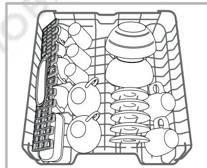
В некоторых моделях посудомоечных машин имеются откидные секции\*, используемые в вертикальном положении для размещения чайных блюдце или десертных тарелочек или в опущенном положении для размещения мисок и пищевых коробок.
